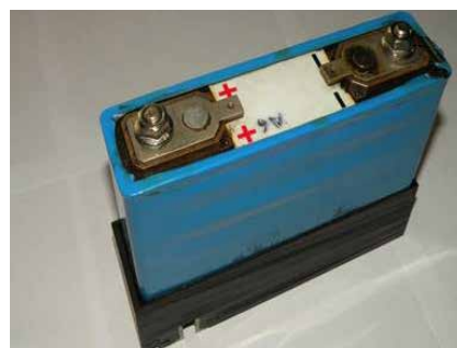
Abbildung 9: Wiederbelebte Lithium-Ionen-Zelle aus einem teildefekten Modul
