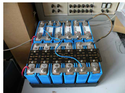
Abbildung 4: Lithium-Ionen-Modul mit Balancer-Platine und darunter:
