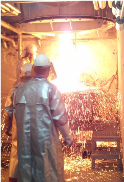
Abb. 2: Abstich am TPT-Flash-Reaktor
