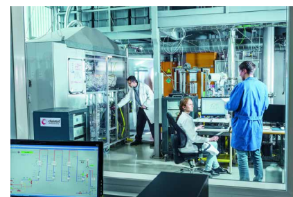
Abbildung 3: Versuchsanlage zur katalytischen Methanisierung am VTIU
