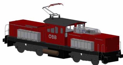
Abbildung 6: Prinzipskizze Batterielok (Batteriekästen seitlich) daneben und -verteilung über Netze gewinnen Anlagen mit Energiebereitstellung aus erneuerbaren Quellen (Photovoltaik, Windkraftwerk, Kleinwasserkraft, Thermoionische
