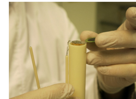
Bild 3: links: Montage einer SOFC-Buttoncell für Testmessungen; rechts: Demonstrationstack (16 Zellen) für Übungsversuche im Labormaßstab.
