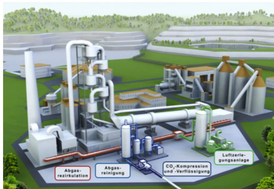
Abbildung 3: Potenzielles Design eines Zementwerks der Zukunft mit Oxyfuel-Technologie © ECRA European Cement Research Academy [6]
