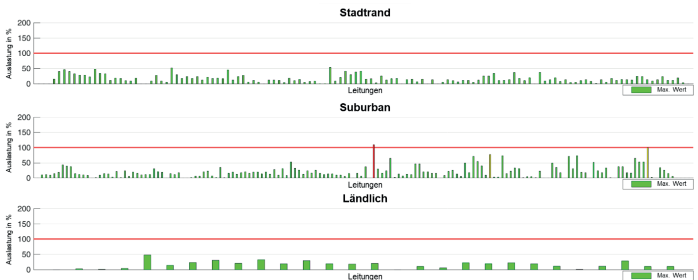
Abb. 6b: Leitungsbelastung bei einer 100 % Elektromobilitätsdurchdringung im Ladeszenario B (Laden mit 3,7 kW)
