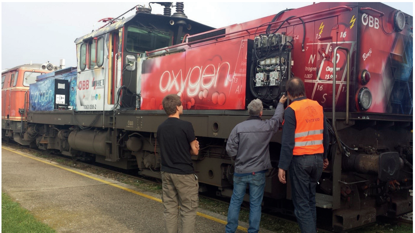
Abb. 1: Umgebaute Hybridlokomotive mit seitlich platzierter Fahrbatterie und DC-Schaltgerüst
